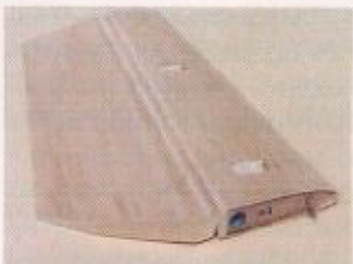
Extra-Höhenruder aus Balsa-Sandwich. Große Ausschläge verstehen sich von selbst.
